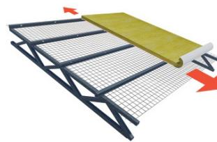
3. Tractionar la malla y la lana en forma conjunta, permitiendo que la lana recupere su espesor entre correas.
