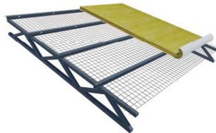
2. Presentar la lana de vidrio por encima de la malla y desenrollar desde el punto más alto en el sentido de la pendiente, con el foil de polipropileno hacia abajo (barrera de vapor) desplegando la solapa.
