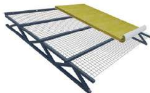
2. Presentar la lana de vidrio por encima de la malla y desplegarla desde el punto más alto en el sentido de la pendiente, con el folio de polipropileno hacia abajo (barrera de vapor) desplegando la solapa.
