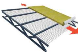
3. Treccionar la malla y la lana en forma conjunta, permitiendo que la lana recupere su espesor entre correas.
