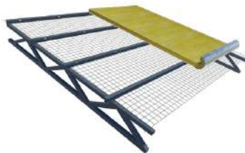
2. Presentar la lana de vidrio por encima de la malla y desenrollar desde el punto más alto en el sentido de la pendiente, con el foil de aluminio hacia abajo (barrera de vapor) descoleando la solapa.
