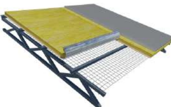
5. Colocar las chapas a medida que se avanza con la instalación para no dejar la lana de vidrio expuesta.
