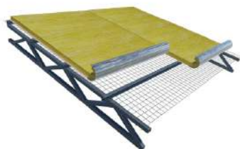
4. Desenrollar el rollo contiguo con la solapa hacia el mismo lado. Unir los rollos superponiendo la solapa de 100 mm con una cinta autoadhesiva.
