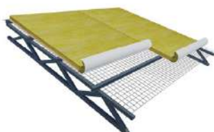
4. Extender el rollo contiguo con la solapa hacia el mismo lado. Unir superponiendo la solapa de 100 mm con una cinta autoadhesiva.
