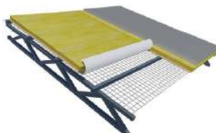
5. Colocar las chapas a medida que se avanza con la instalación para no dejar la lana de vidrio expuesta.
