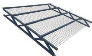
1. Colocar la malla plástica en sentido transversal a las correas.
