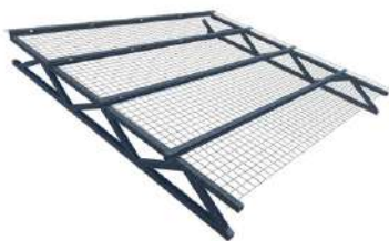
1. Colocar la malla plástica en sentido transversal a las correas o la instalación de alambre cada 30cm aproximadamente.
